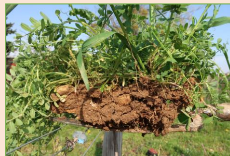
« Test-bêche » pour évaluer la compaction du sol
